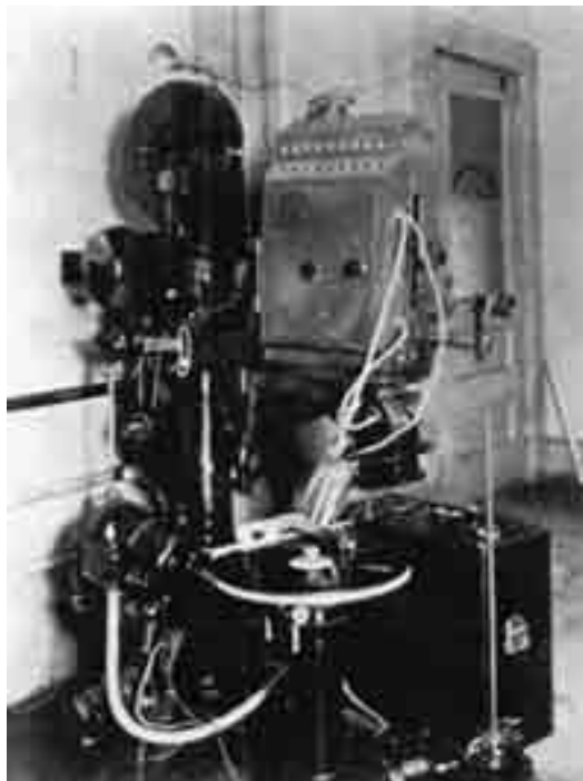
Figura 1: O Sistema VITAPHONE, um projetor com uma vitrola acoplada
