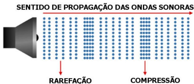
Imagem 1: Esquema de uma onda sonora, com uma fonte sonora à esquerda apontada para a direita, onde se encontram regiões de compressão e rarefação das moléculas de ar, como consequência da vibração da fonte.
